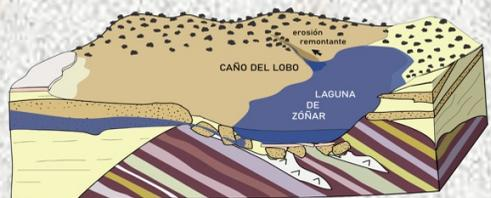
La zona hundida se llena de agua procedente, tanto de la escorrentía superficial como de los aportes subterráneos. El agua de escorrentía, en erosión remanente, ha excavado en las arenas calcáreas o calcarenitas el Caño del Lobo, el barranco que se observa desde este punto.
