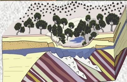
La disolución de la halita y el yeso produce el hundimiento de los terrenos suprayacentes.
